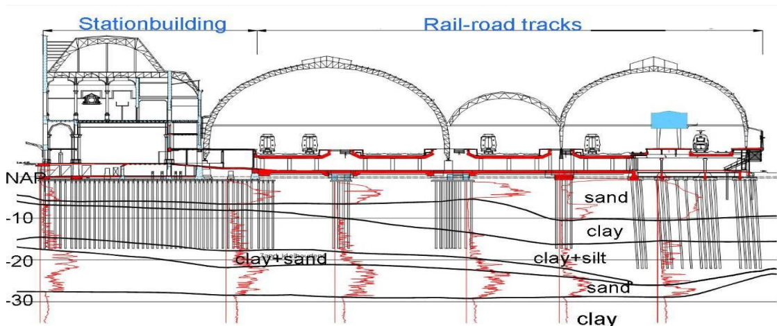
Bild 2 Längsschnitt Bahnhofsgebäude und Gleisanlagen
