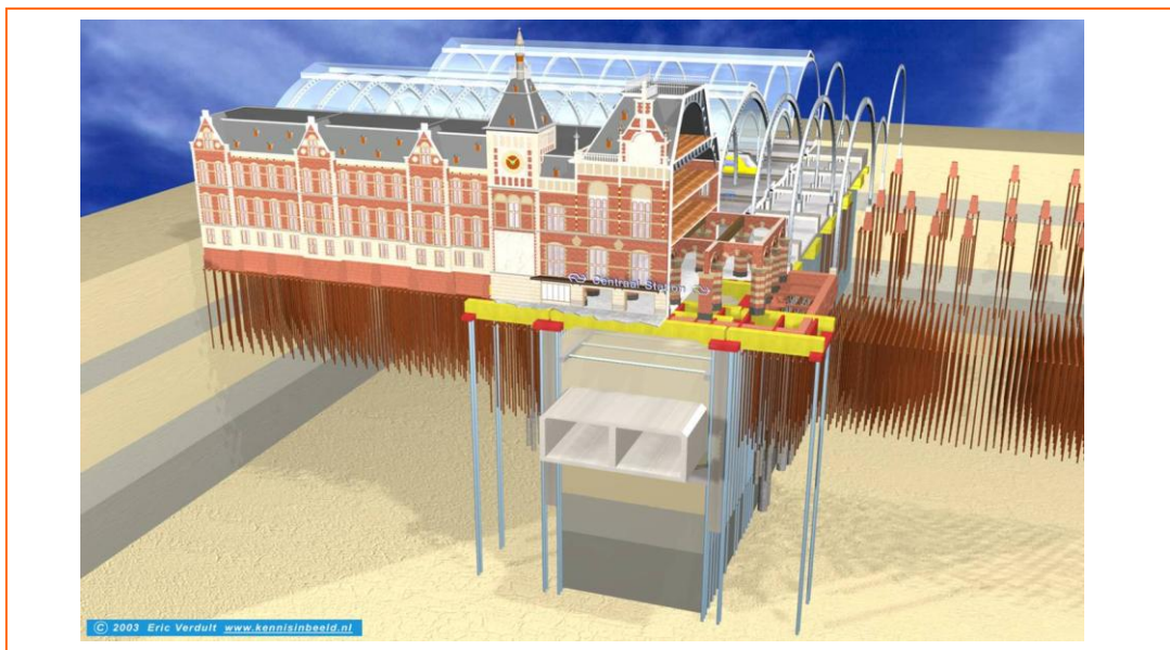
Bild 1 Bahnhofsgebäude mit neuem Tunnel
